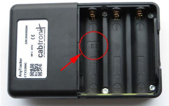
SIM-Kartensymbol im Batteriefach lokalisieren und die SIM-Karte in der gleichen Lage in das Batteriefach legen.
