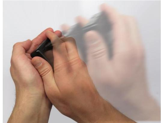
Schlagen Sie nun die Hand mit dem AnyTracker V2 in die Wanne, die Sie mit der anderen Hand formen. Durch seinen Schwung löst sich der Akku problemlos aus dem Akkufach, und trotzdem entsteht kein unnötiger Zug auf das Anschlusskabel.
