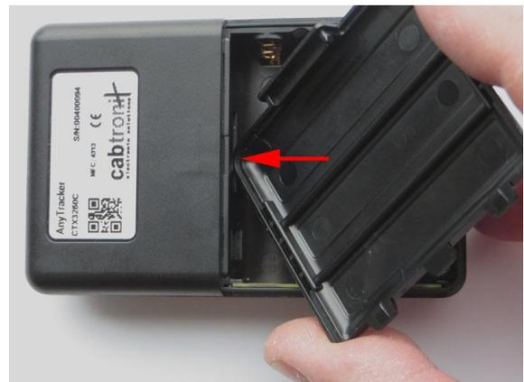
Mit der Ecke des Batteriefachdeckels kann die SIM-Karte ganz in den SIM-Kartenschlitz gedrückt werden. Erst am Anschlag rastet der Kartenhalter ein, und die SIM-Karte wird nicht mehr per Federkraft herausgedrückt.
